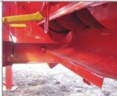
Como opcional se provee a la base del sinfin horizontal con sistema de desenganche rápido (sistema patentado OMBU), lo que evita el estancamiento de agua y desechos, facilitando la limpieza de la tolva para casos de acarreos de distintas variedades de granos. Imprescindibles en recolección para sembreros.
