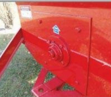
Enganche trasero y tapa de bancada del sinfin horizontal ambos desmontables
